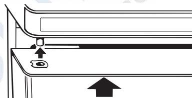
7. Установите и завинтите нижнее крепление дверцы с опорной шейкой слева снизу на дверце морозильной камеры.
