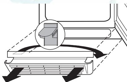
2. При закрытой дверце морозильной камеры вывинтите винт с крестообразно-шлифцевой головкой из нижнего крепления дверцы и снимите крепление движением вниз.
