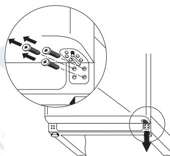
3. Снять переднее крепление с дверной опоры (1, 2). Опорную шейку переставить из правого в левое отверстие (3). Установить имеющееся в комплекте поставки дверное крепление на опорные шейки (4, 5).
